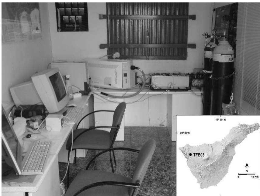
Fig. 14. Estación geoquímica para el seguimiento y medida en modo continuo de gases disueltos en las aguas subterráneas en Santiago del Teide, Tenerife.
