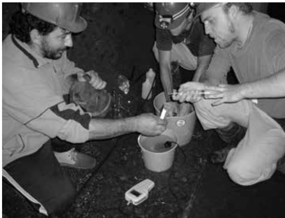
Fig. 13a. Rayco Marrero (ITER) procediendo a la toma de muestras de aguas subterráneas en el interior de una galería para su posterior análisis químico de los gases disueltos, así como de los cationes y aniones mayoritarios.
