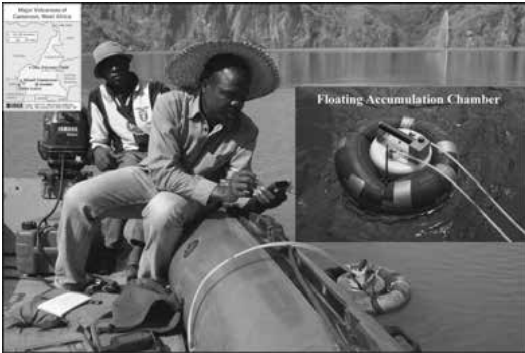
Fig. 37. Equipo ITER-IGMR (Camerún) realizando medidas de emisión difusa de dióxido de carbono ( \text{CO}_2 ) en el lago volcánico Nyos, Camerún.
