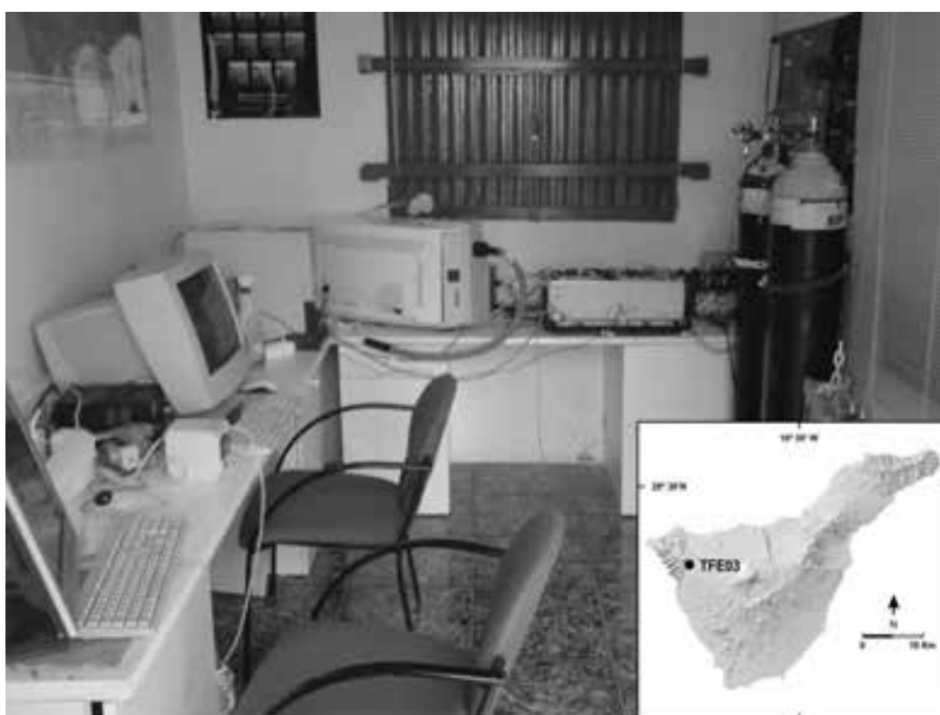
Fig. 14. Estación geoquímica para el seguimiento y medida en modo continuo de gases disueltos en las aguas subterráneas en Santiago del Teide, Tenerife.
