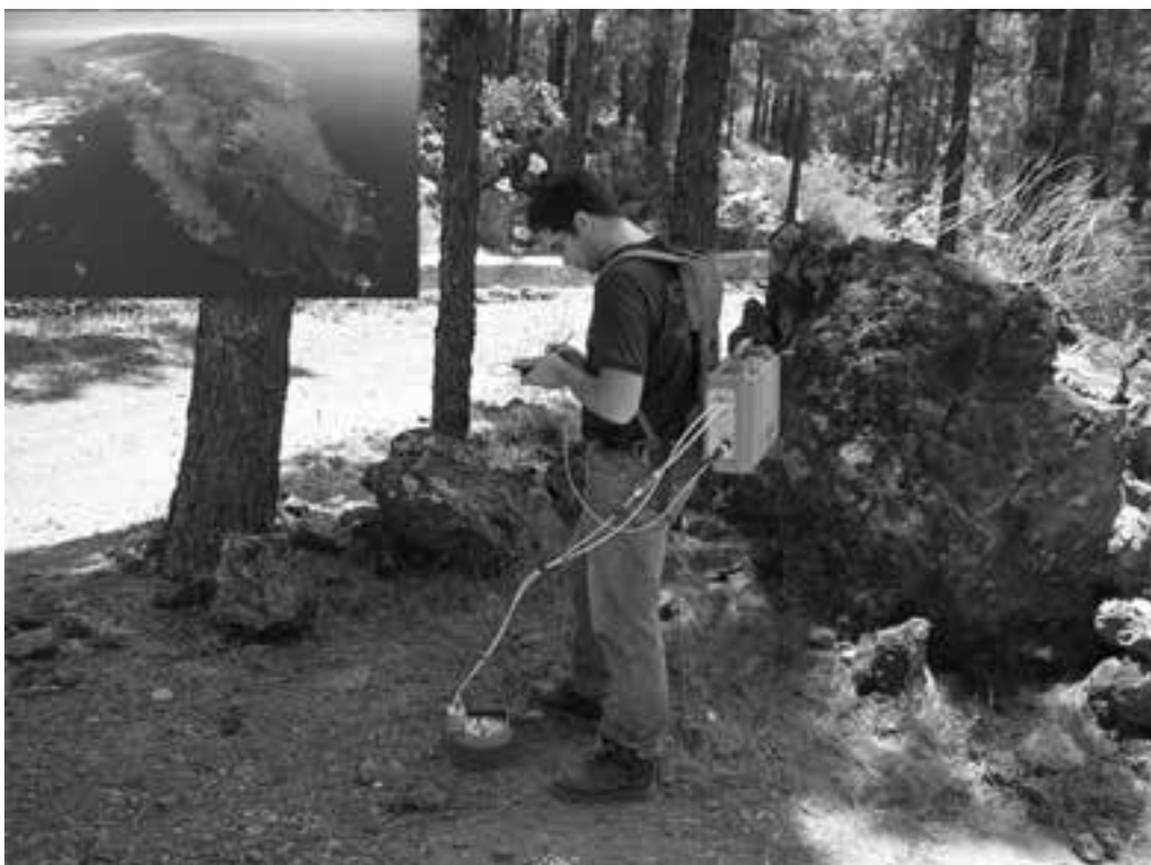
Fig. 10. Eleazar Padrón (ITER) realizando medidas de flujo difuso de dióxido de carbono ( \text{CO}_2 ) en el volcán Cumbre Vieja, La Palma.
