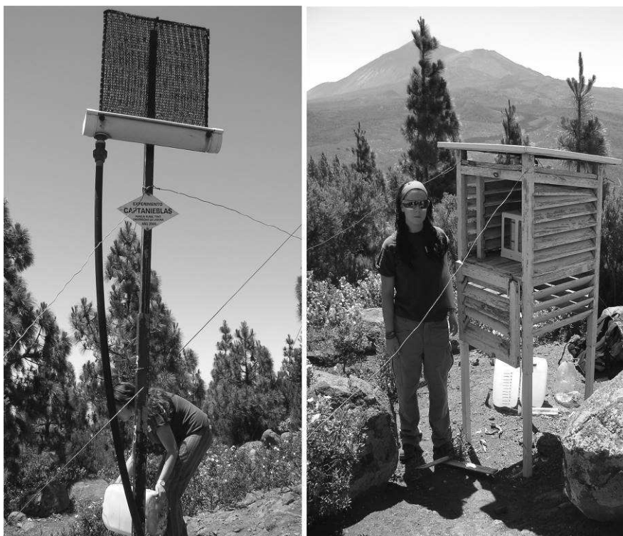
Fig. 14. Las imágenes muestran como las vigilantes María Pérez y Fátima Afonso contabilizan el agua colectada por uno de los captanieblas después de un día con niebla en la torre y la segunda realiza el cambio de banda de un termohigrógrafo situado dentro de una garita meteorológica. © M a V. Marzol.
