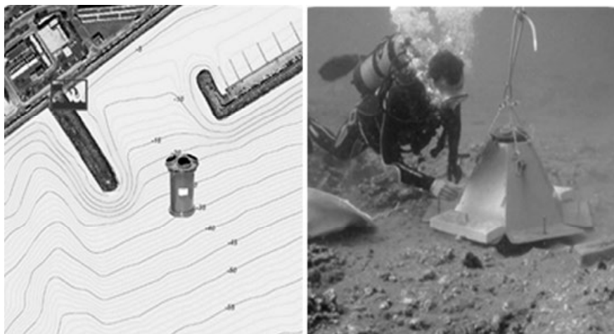
Fig. 11. El perfilador de corrientes mide la velocidad y la dirección del flujo de la corriente en un punto con coordenadas y profundidades determinadas.
