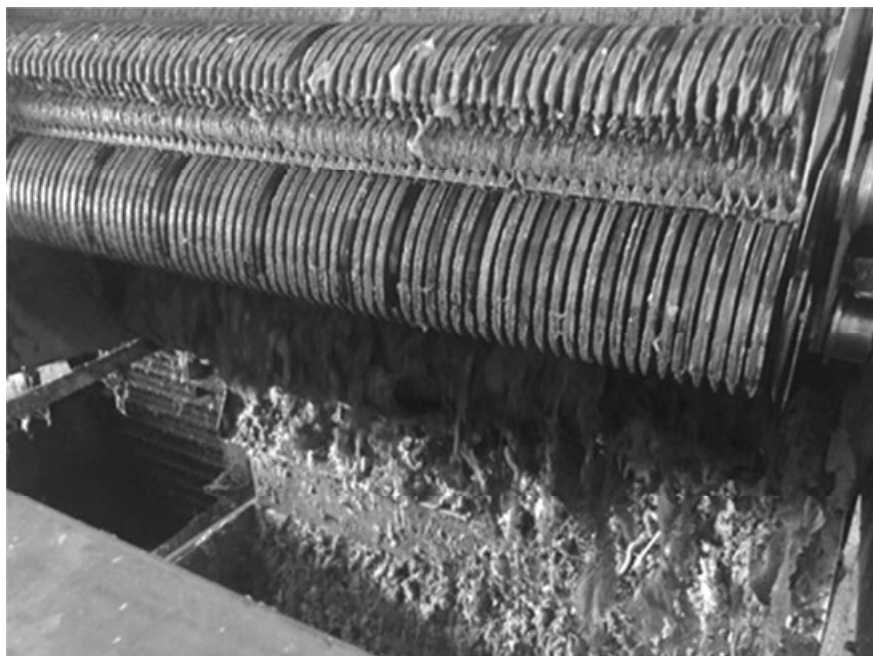
Fig. 2. Equipo de cribado y eliminación de sólidos habitual en Tratamiento previo-primario de EDAR.
